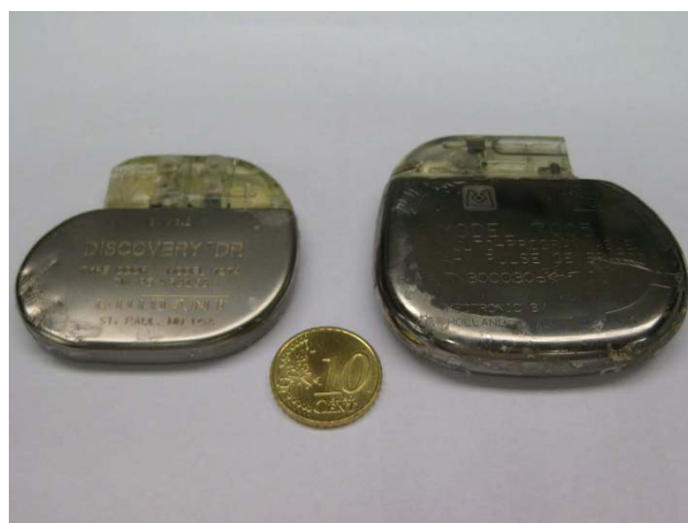
Рис. 9b: Два поколения кардиостимуляторов. Слева - кардиостимулятор 2000 г, справа - кардиостимулятор 1984 г. Оба кардиостимулятора находились в теле в течение 7 лет.
